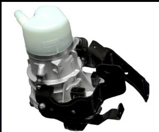
Zintegrowana pompa wspomagania ze zbiornikiem oleju
