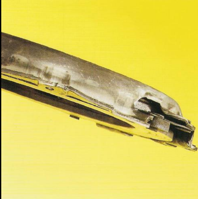
Wykrzywiona obudowa sprzęgła
