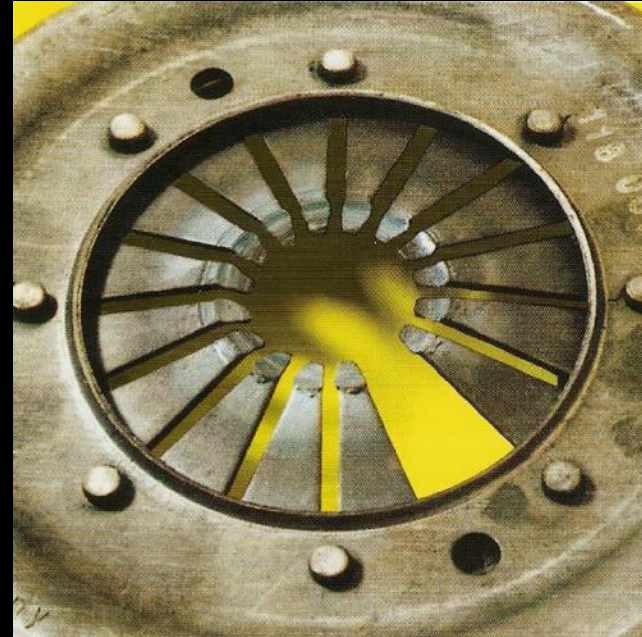
Wytarte końcówki sprężyny talerzowej
