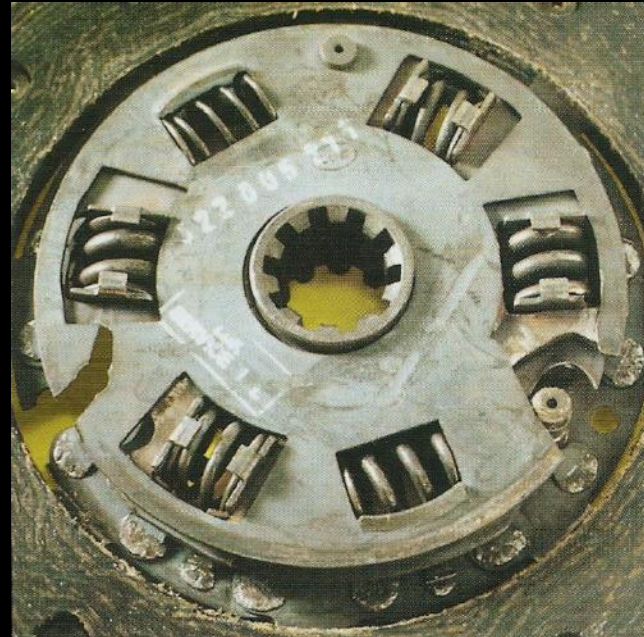
Zniszczona blaszana pokrywa tłumika drgań
