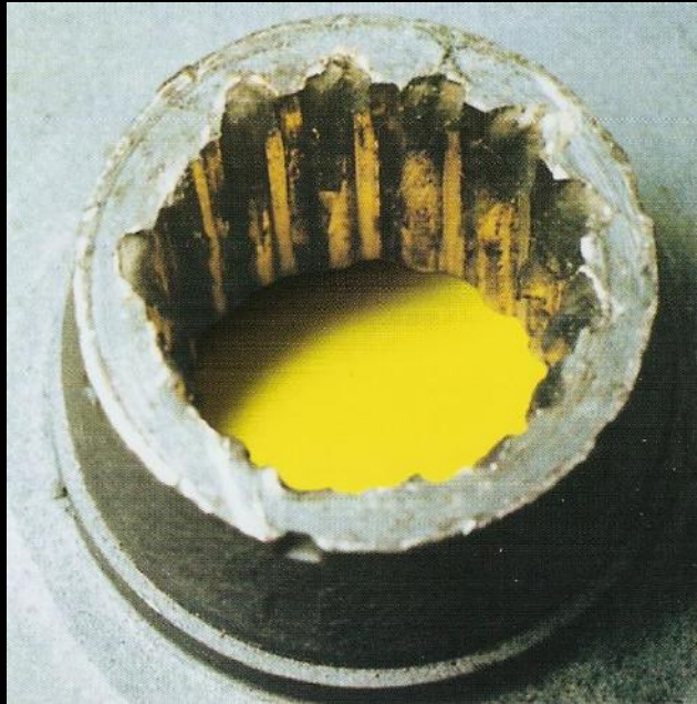
Uszkodzony profil zębaty piasty
