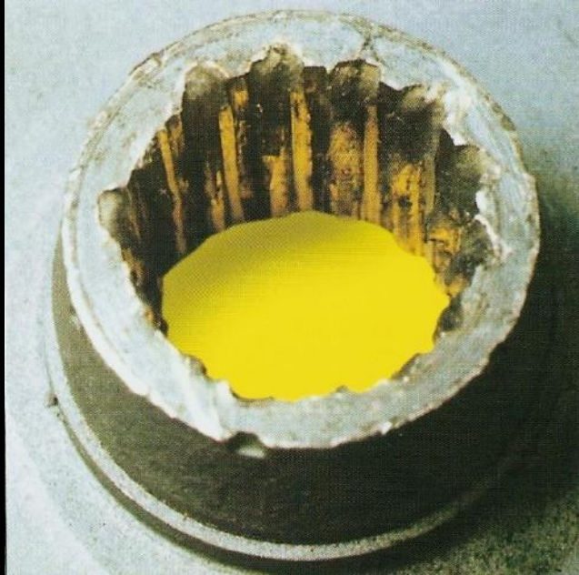
Uszkodzony profil zębaty piasty
