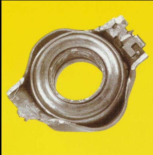
Wygięta obudowa łożyska
