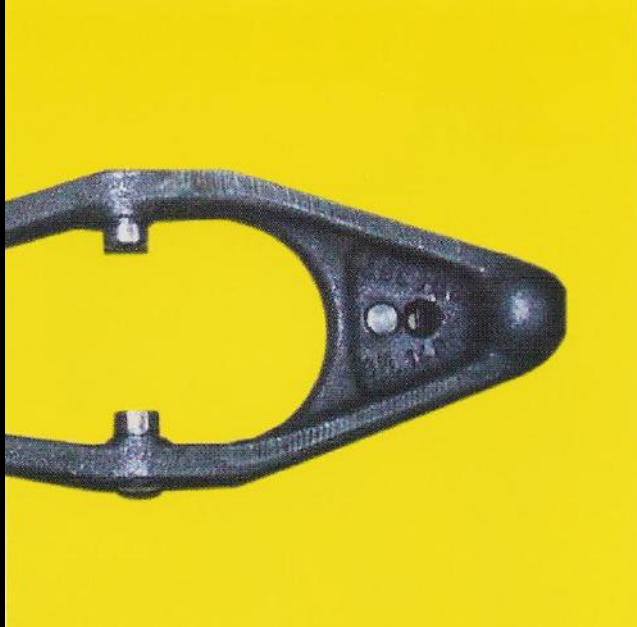
Zużyte widełki wysprzęglające
