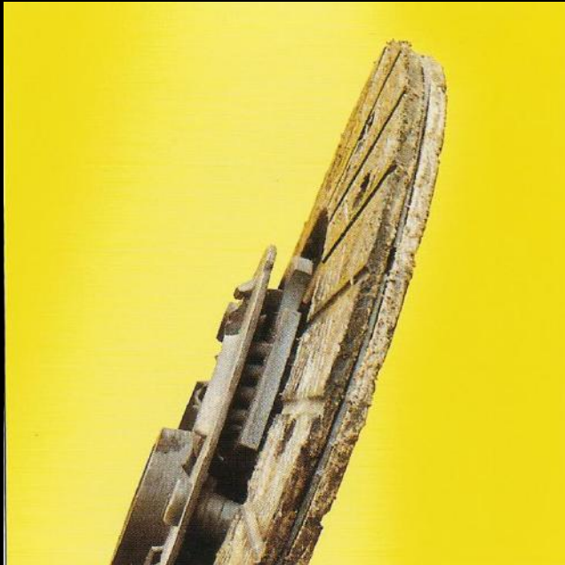
Odkształcenie tarczy sprzęgła od płaszczyzny (bicie boczne)
