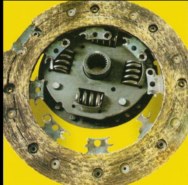
Nośnik okładziny równomiernie połamany
