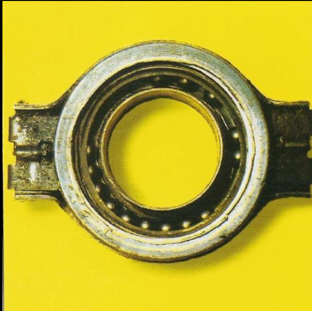
Zniszczona tuleja i łożysko oporowe
