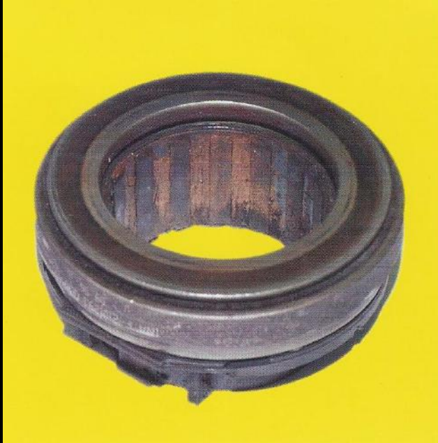
Łożysko oporowe niewłaściwie nasmarowane
