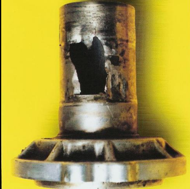
Uszkodzona tuleja łożyska oporowego
