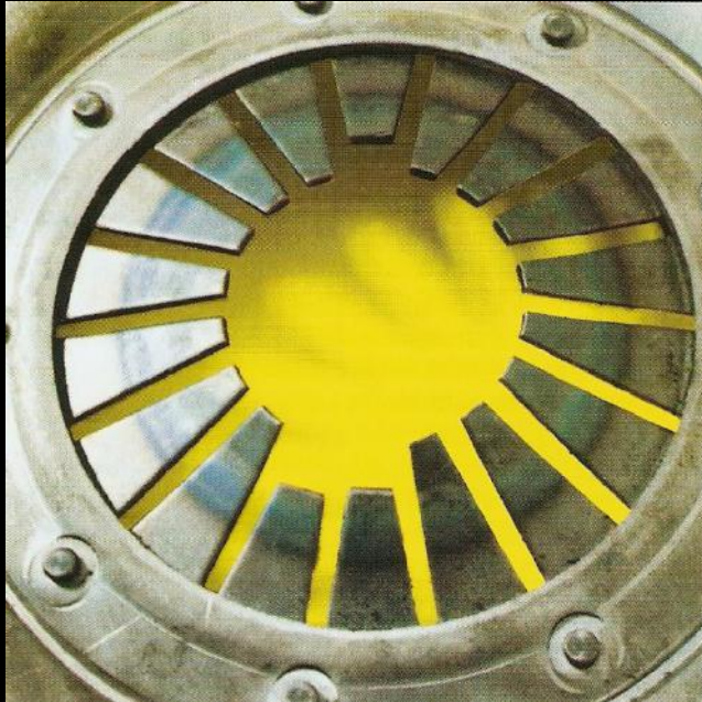
Złamane końcówki sprężyny talerzowej
