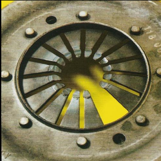
Wytarte końcówki sprężyny talerczowej
