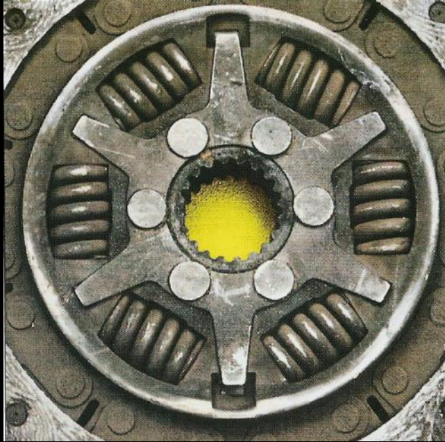
Ślady tarcia na tłumiku drgań skrętnych
