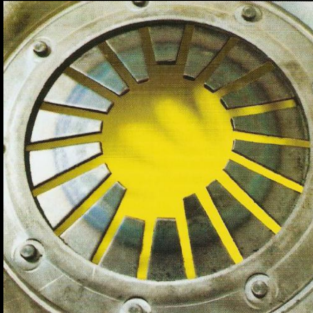
Wytarte końcówki sprężyny talerzowej
