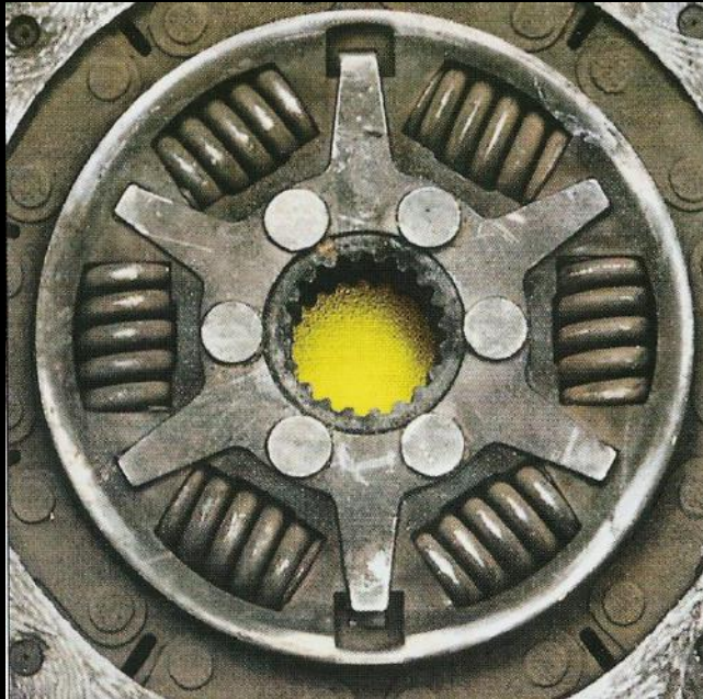
Ślady tarcia na tłumikach drgań
