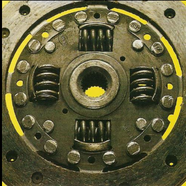
Ślady tarcia na główkach nitowania segmentowego (VW)
