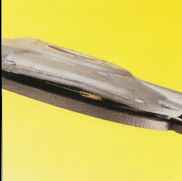
Wykrzywiona pokrywa sprzęgła (VW)
