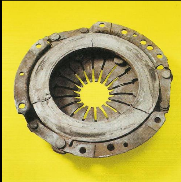
Pęknięta tarcza docisku
